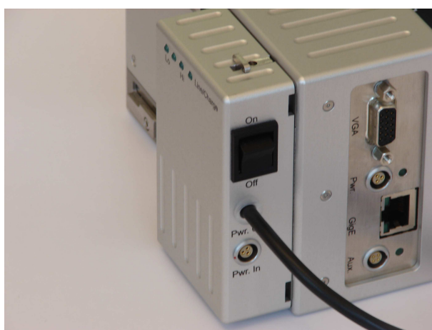
Schritt 3: Ladegerät in Verriegelungsposition schieben
