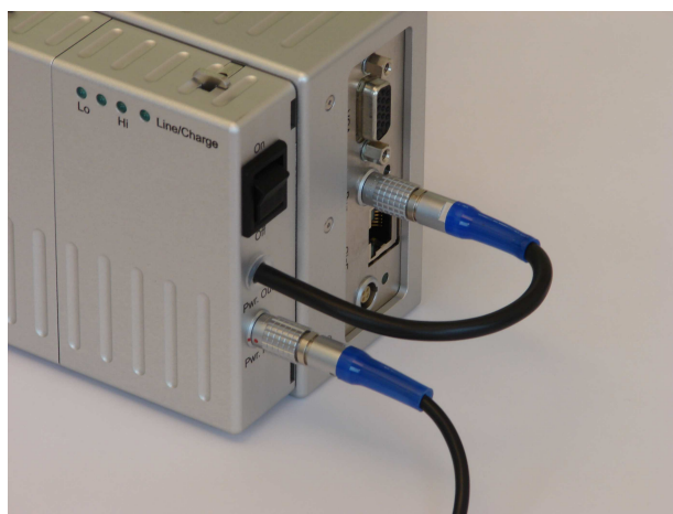
Schritt 6: Schalter in „off“ Position, Kamera mit AccuPack verbinden
