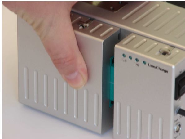
Schritt 4: Lilon Accu ansetzen und andrücken
