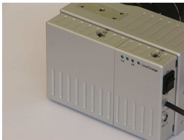
Schritt 5: LilonAccu nach rechts in Verriegelungsposition schieben
